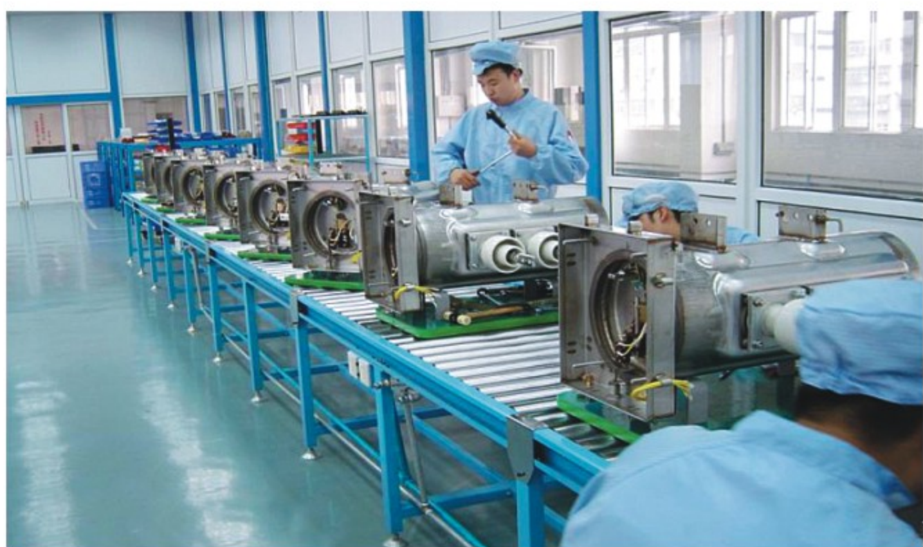
■ Производственная линия сборки выключателя нагрузки
